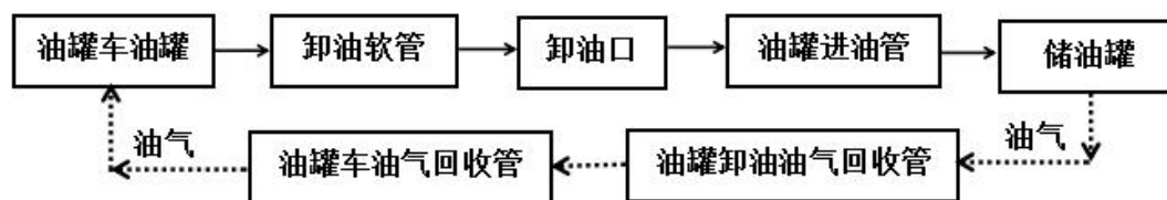
图2.4-4 汽油卸油工艺流程框图
