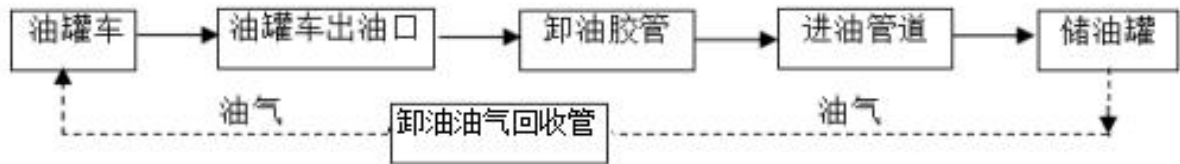
图2-7汽油卸油工艺流程框图
